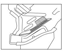
INSTALL THE FILTER TO THE DRAIN COVER AS SHOWN
